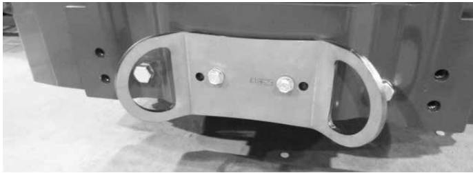
Zurrpunkthalterung A418623 am hinteren Stoßfänger oder Zusatzgewicht installiert
