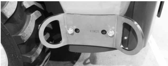
Zurrpunkthalterung A418623 seitlich am Hinterwagen installiert. Für die seitliche Montage sind zwei Halterungen erforderlich.
